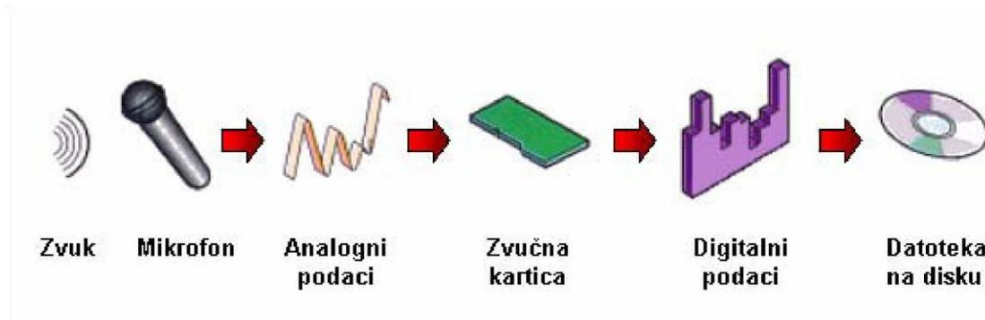
Ključni korak u ovom postupku pretvorba je analognog električnog signala u digitalni oblik. Analogno-digitalni (AD) pretvornik u zvučnoj kartici mjeri ulazni električni signal i dobivene vrijednosti zapisuje kao niz brojeva tj. uzoraka. Niz uzoraka tvori digitalni zapis zvuka.
